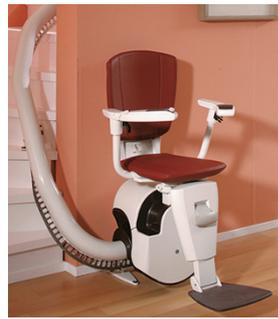
最大積載量90kg、ジョイスティック操作、レール角度0~70度。障害物感知センサー、回転いすセンサー、安全ベルトなどの安全装置つき。屋内・曲線階段用。
