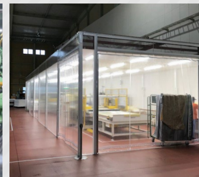
作業空間の間仕切り
