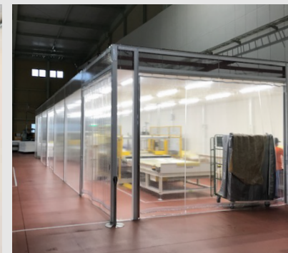
作業空間の間仕切り
