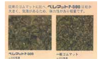
従来のゴムマットに比べ、ペレマットP-500は幅が大きく、気泡があるため、弾力性があり軽量です。
