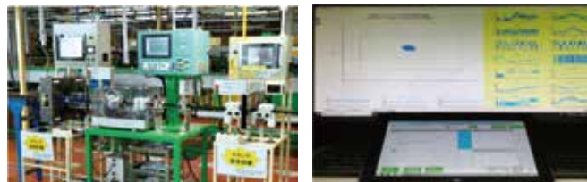
パイプの自動測定機 インラインで外径、肉厚、外観検査を自動測定器で実施し、異常を見逃さない
